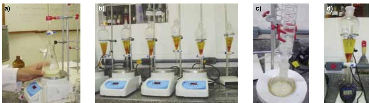
**Figura 1 – Titulação sob agitação para índice de acidez (a); avaliação da eficiência dos catalisadores (b); aquecimento da amostra para índice de saponificação (c); separação de fases após reação de transesterificação (d).**
